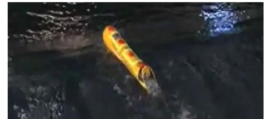
Skalert modell av Torpedostuparen, testet på MARINTEK. Bilder: skjermdump fra video fra klosterrescuesystem.no
